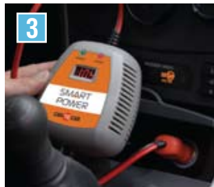
▼ Этапы проверки зарядного устройства: подключение к прикуривателям машин (фото 1-2), контроль напряжения до (фото 3) и после заряда аккумулятора (фото 4)
