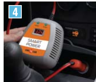
▼ Этапы проверки зарядного устройства: подключение к прикуривателям машин (фото 1-2), контроль напряжения до (фото 3) и после заряда аккумулятора (фото 4)
